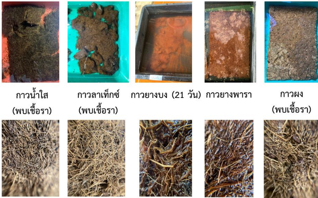
รูปที่ 4.14 ลักษณะแผ่นคอมโปสิตและเส้นใยมะพร้าวหลังการทดสอบย่อยสลายเป็นเวลา 2 เดือน
