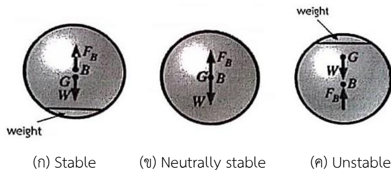
รูปที่ 2.81 เสถียรภาพของวัตถุจม (ก) Stable (ข) Neutrally stable (ค) Unstable [63]
